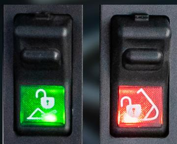
Interruptor de seguridad (cargadora)    Interruptor de seguridad (retroexcavadora)
