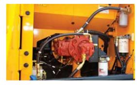
Para lograr una precisión óptima, Hyundai rediseñó el sistema hidráulico para brindar al operador un toque de primera calidad y control mejorado. El control mejorado del flujo de la bomba reduce el flujo cuando los controles no se usan para minimizar el consumo de combustible.
